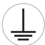
1159 70 10 messa a terra
